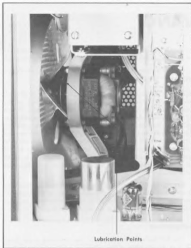
Fig. 4-1. Fan motor lubrication points.
